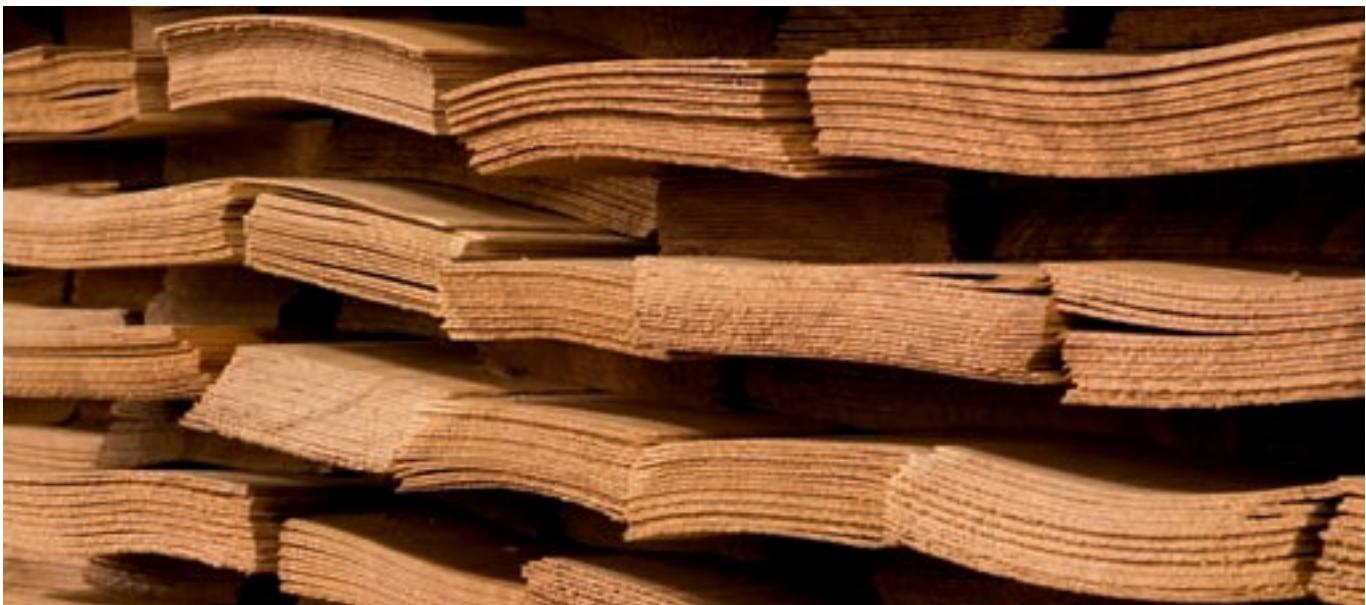
vengono accoppiati con la tecnica delle fibre incrociate (da 5 a 7 strati) incollati e pressati essi consentono di ottenere manufatti di legno con altissime performance di stabilità con minori rischi agli attacchi di tarlo, più elastici, omogenei e con maggiore cura nella scelta delle parti a vista.
