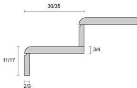
PEDATE A COSTA A MEZZO TORO DI SEZIONE 30/35 CM. – ALZATE LISCIE DI SEZIONE 11/18 CM, SUPERFICIE LEVIGATA/SPAZZOLATA
