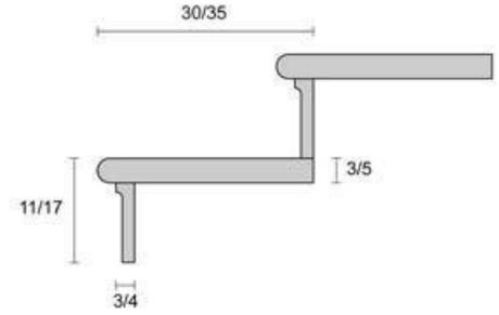
PEDATE A COSTA A TORO DI SEZIONE 30/35 CM – ALZATE LISCE DI SEZIONE 11/17 CM, SUPERFICIE LEVIGATA/SPAZZOLATA\*
